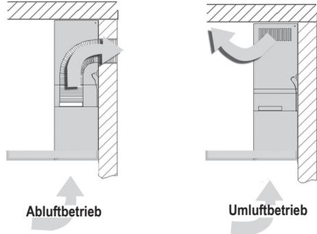
Bei **Abluftbetrieb** wird der Wrasen über ein Abluftsystem mit Mauerkasten ins Freie geführt.
